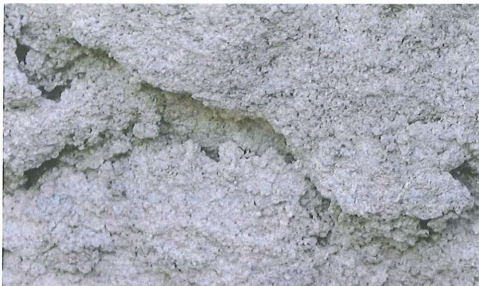
21. Powiększenie x 10. Widoczna struktura zdegradowanego elementu.
