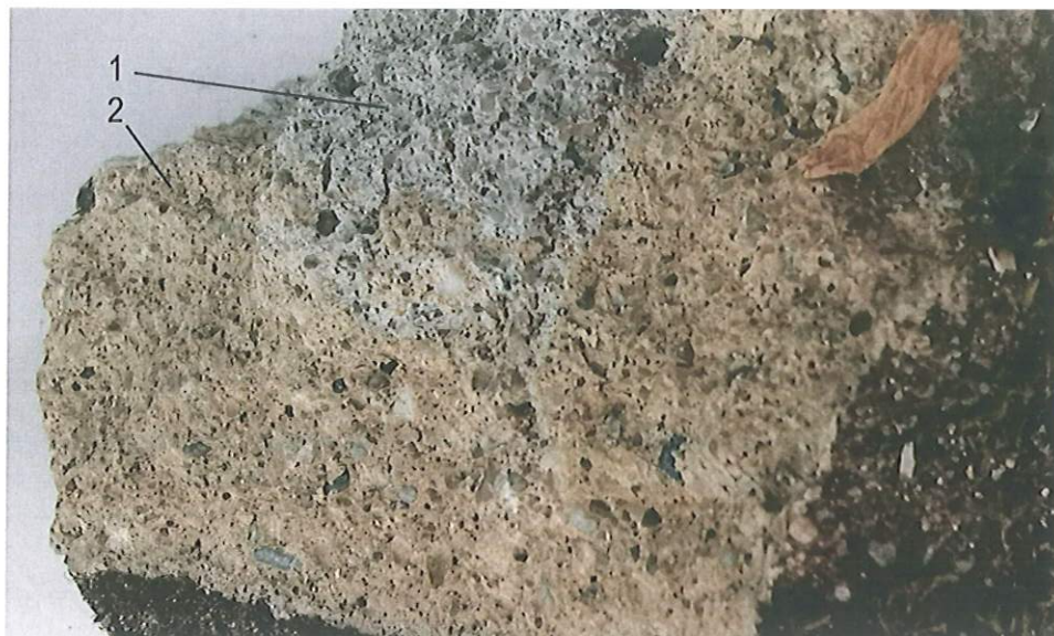
51. Fotografia fragmentu ubytku w obramowaniu. Widoczne warstwy: 1 – spodnia (rdzeniowa), 2 – wierzchnia (barwiona w masie).
