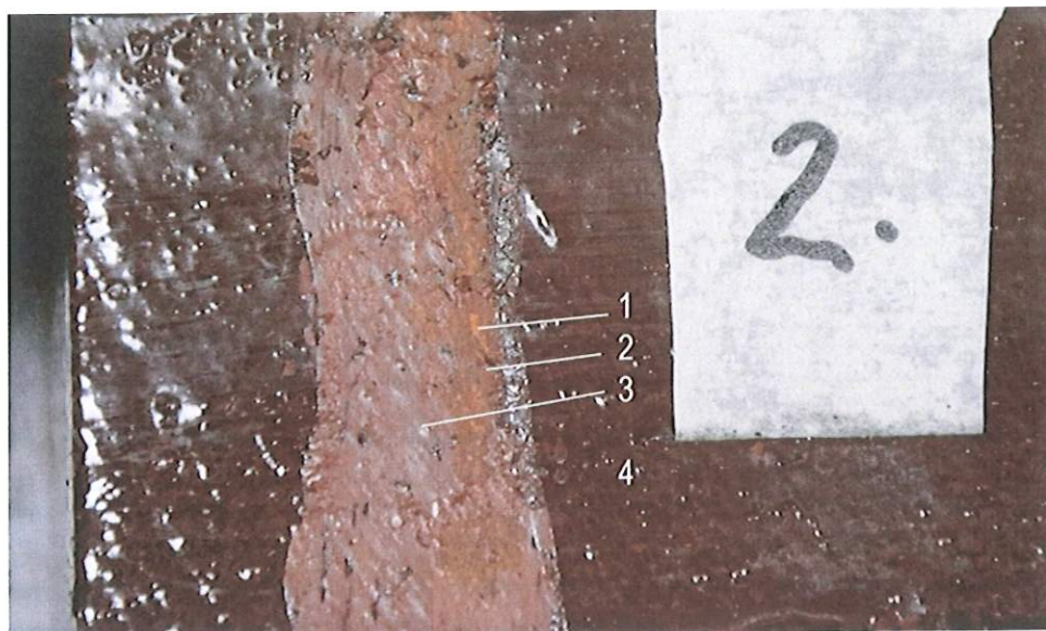
13. Słup empory (pkt 2). Widoczna stratygrafia warstw: 1-drewno, 2-warstwa malarska czerwono-brązowa, 3- warstwa malarska siena palona, 4- warstwa malarska umbra palona.
