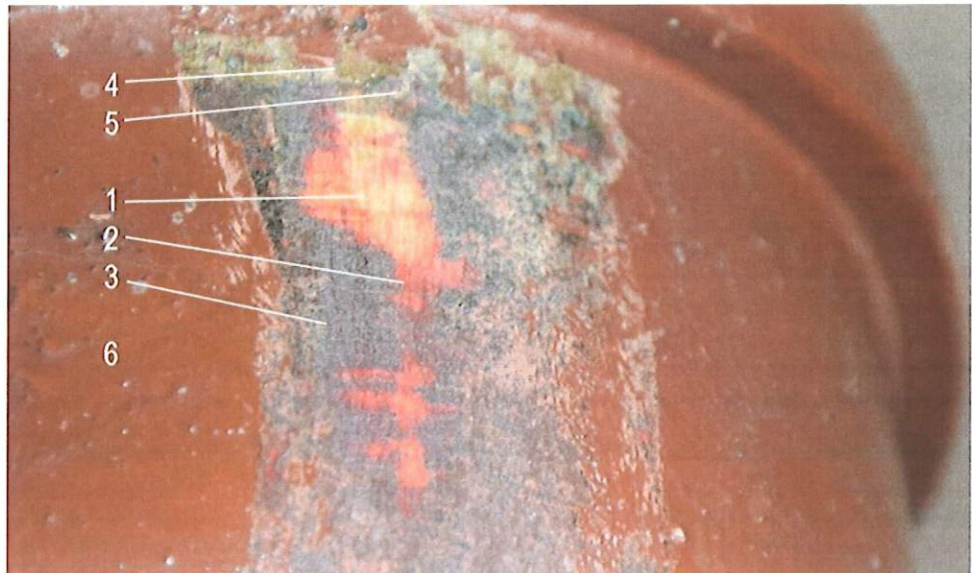
25. Detal dekoracyjny „szyszka” (pkt 16). Widoczna stratygrafia nawarstwień: 1-drewno, 2-warstwa malarska czerwona, 3- warstwa malarska ciemnobrązowa, 4- warstwa malarska zielona, 5- warstwa malarska rozbielona siena, 6 - warstwa malarska siena palona.
