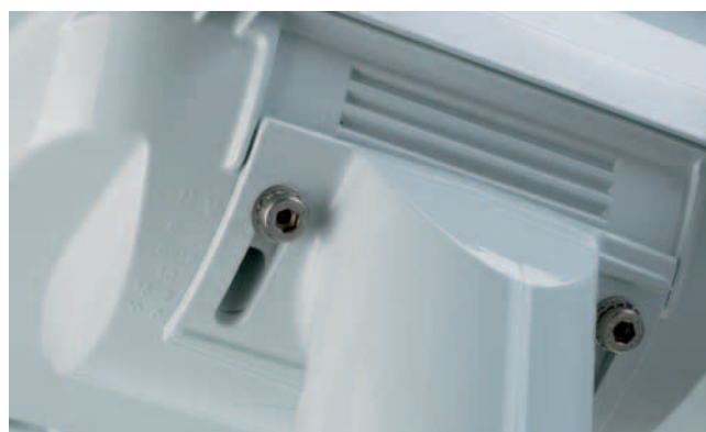
Uniwersalny układ montażowy wykonany z odlewu aluminiowego do instalacji na wysięgniku lub słupie, z możliwością regulacji pochylecia oprawy w pionie od 0° do -20° i poziomie od 0° do 15°.
